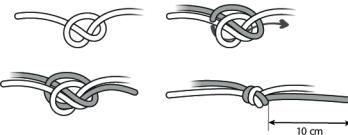
With double Fisherman's knot / Nœud de pêcheur double
