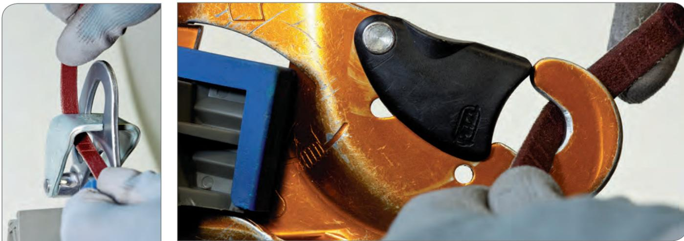
下降器『ストップ』および『シンプル』のポピンは、交換用パーツとして入手可能です。パーツが摩耗した際に交換してください（取扱説明書をご参照ください）。
