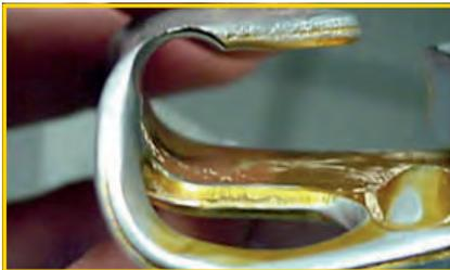
ロープの摩擦によりフレームが磨耗してできた鋭いエッジ (廃棄)
