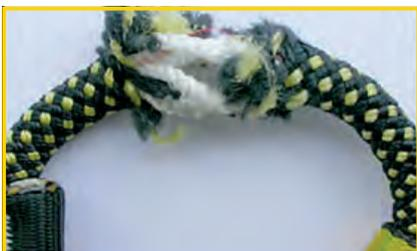
**外皮の切断、芯の損傷 (廃棄)**
