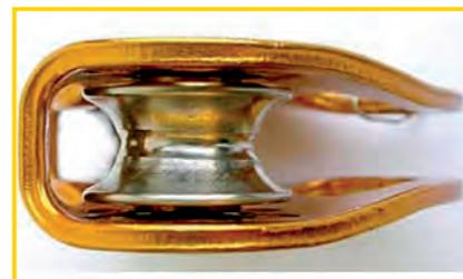
細すぎるケーブルを使用したことによる滑車の磨耗 (廃棄)
