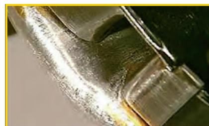
サイドプレートがロープと摩擦する部分で磨耗している (注意が必要)
