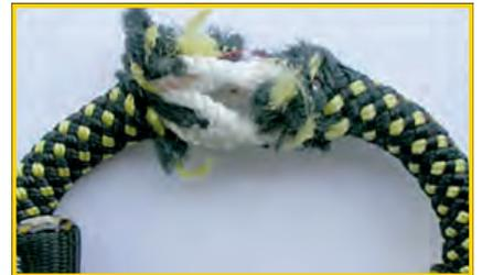
外皮の切断、芯の損傷 **(廃棄)**
