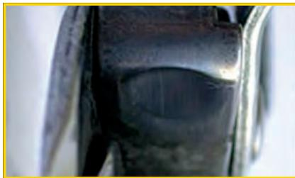
摩擦部分のロープによる磨耗、サイドプレートの鋭いエッジ (注意が必要)
