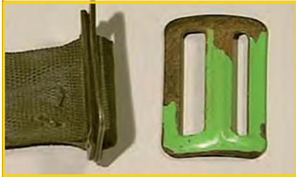
調節バックルの変形と腐食 (廃棄)
