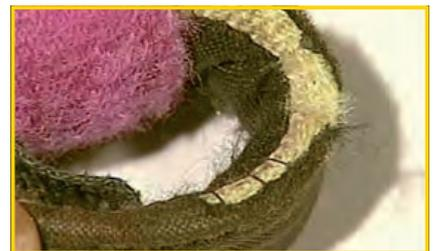
保護カバーの損傷、内部のウェビングも損傷
