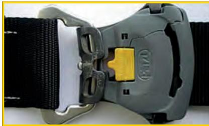
「FAST」バックルのプラスチック部分の破損
