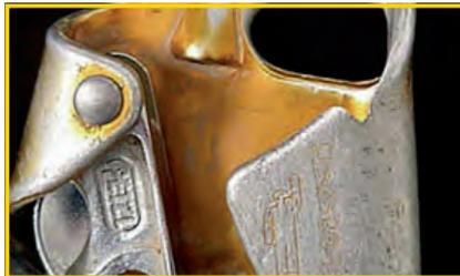
ロープの摩擦によりフレームが磨耗してできた鋭いエッジや欠けた箇所 (廃棄)
