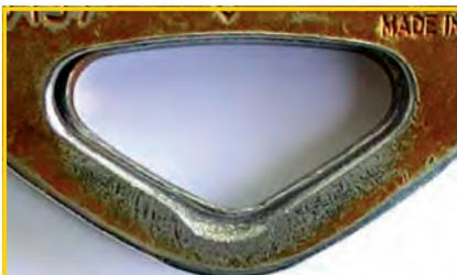
**アタッチメントポイントが、コネクターと接触する部分にかかる荷重で変形 (注意が必要)**
