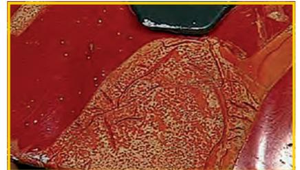
化学薬品による損傷の跡 (廃棄)
