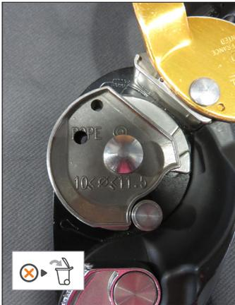
• 衝撃荷重によって変形したアタッチメントホール
