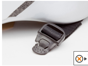
• バックルの破損
