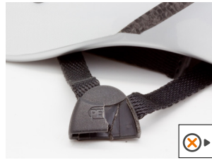
• バックルの破損
