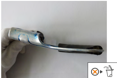
• 変形したフレーム
