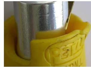
・ ロッキングスリーブの損傷
