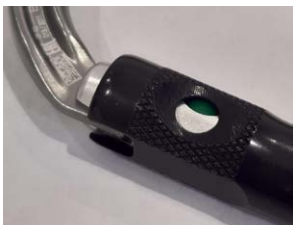
・ ロッキングシステムの不良
