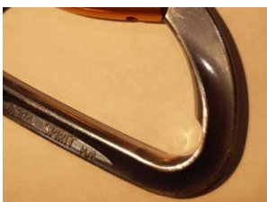
・ ロープによって摩耗したフレーム
