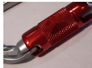
・ ロッキングシステムの不良
